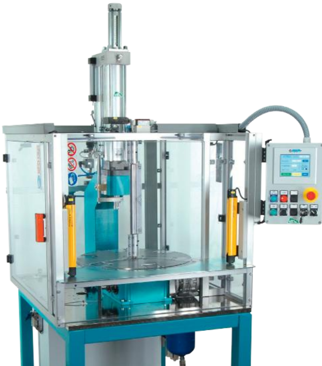
Montagemaschine mit mechanischem Drehtisch und hydropneumatischer Presse G.P.A. mit kN 40.
